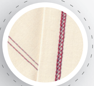
3-draads coversteek 3 mm voor het omzomen, voor biesjes naaien, voor siereffecten
