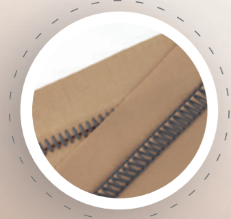
3-Draads flatlock breed Rekbare naad voor elastische stoffen
