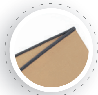
4-Draads overlock stevige naad voor de verwerking van gangbare stoffen
