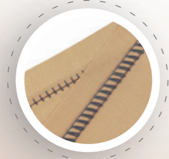
3-Draads flatlock smal Rekbare naad voor elastische stoffen
